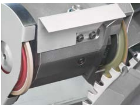
Spanflächenbearbeitung rechtes Spindelende
