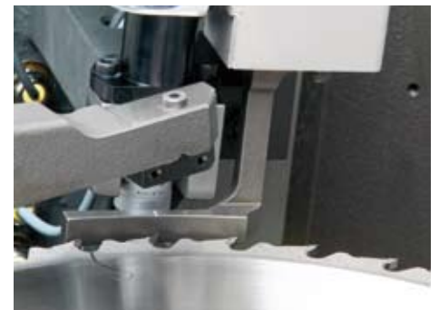
Sägenanschlag im Arbeitsraum
